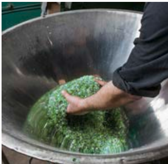
Le bottiglie PET scorrono dentro un separatore di metalli. Ciò consente di eliminare anche le etichette che contengono alluminio. Dopodiché le bottiglie entrano in una macina che le sminuzza a pezzetti di 12 mm.
